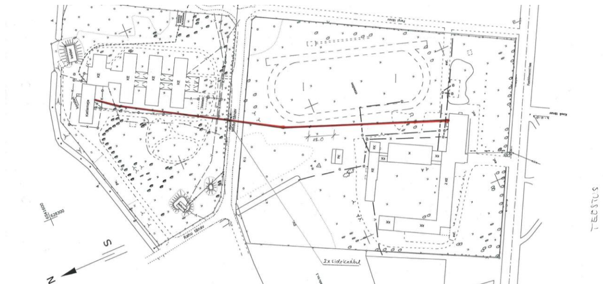
Joonis 6.7 Niidu tn kaugküttevõrgu skeem
