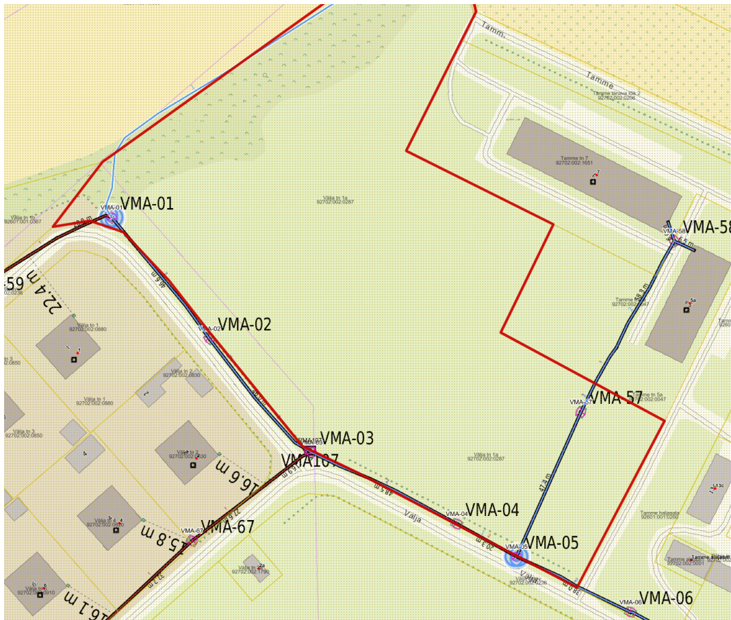
Skeem 4. Telia Eesti AS poolt koostatud skeem sidetrasside ja kaevude paiknemise kohta.
